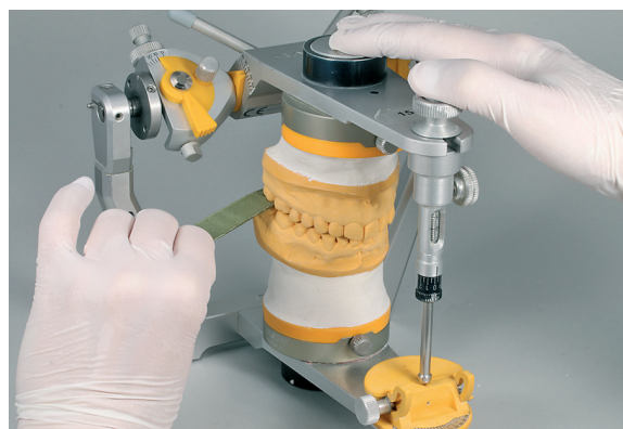
Abb. 25: Aluwax-Check über dem ersten zentrischen Kontakt.
