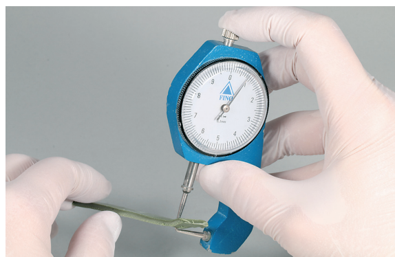
Abb. 26: Messen der eingestellten Vertikalspernung für die Schiene – Distanzkontrolle.
